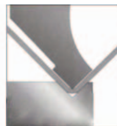
Abb. 2 90° Stempel, Spitzenradius R 0,8 mm
