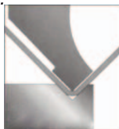
Abb. 1 90° Stempel, Spitzenradius R 0,2 mm
