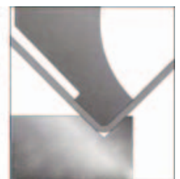
Abb. 3 90° Stempel, Spitzenradius R 1,5 mm
